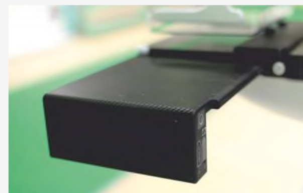
Цифровой приемник «СОЛО ДМ-МТ» легко вставляется в кассетоприемник
